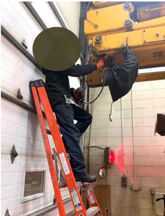
FIGURE 8 — Baie dédiée aux véhicules lourds, l'espace en arrière de la porte ne permet pas de travailler de façon sécuritaire – une échelle doit être appuyée sur la porte de garage pour être en mesure de faire l'entretien du véhicule
