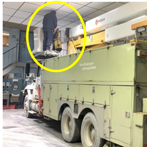
FIGURE 5 — Mécanicien travaillant en hauteur sur le dessus d'un camion nacelle - aucun harnais de sécurité n'est disponible ou utilisé. Non sécuritaire - la tête du mécanicien touche le plafond. Le mécanicien doit se déplacer en étant penché - pratique non sécuritaire
