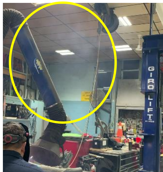
FIGURE 11 — Fumée visible non captée à la source
