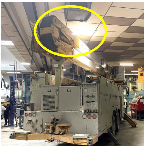
FIGURE 4 — Espace exigü pour déplacer les véhicules dans l'atelier. Risque d'accrocher le système de chauffage au plafond
