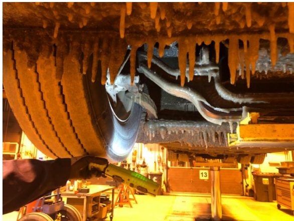
Photo 2 – Véhicule devant être déglacé avant de procéder à l'inspection
