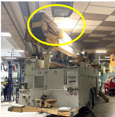
FIGURE 4 — Espace exigu pour déplacer les véhicules dans l'atelier. Risque d'accrocher le système de chauffage au plafond
