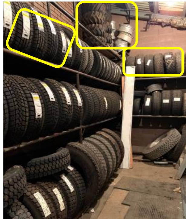
FIGURE 9 — Les pneus sont entreposés en hauteur et sont montés et descendus manuellement par un mécanicien sur une échelle – non sécuritaire
