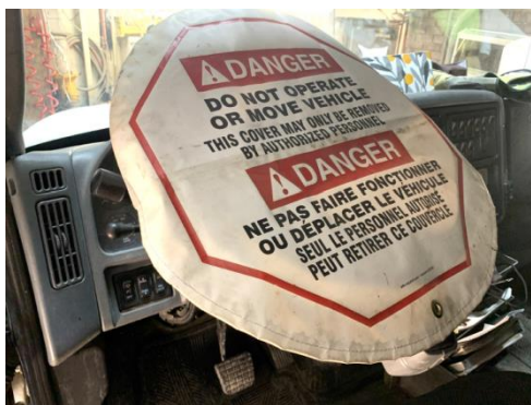
FIGURE 1 — Volant recouvert pour aviser le client si un véhicule est hors service
