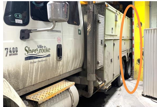
FIGURE 7 — Espace de manœuvre très réduit entre un véhicule lourd et le côté de la porte de garage lorsque vient le temps de sortir un véhicule - risque d'accrocher le côté de la porte de garage
