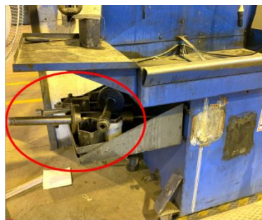
Photo 6 – Outillage laissé dans un bac d'égouttement d'un lave-pièces
